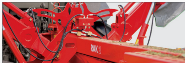
Блокування роторів в транспортному положенні
