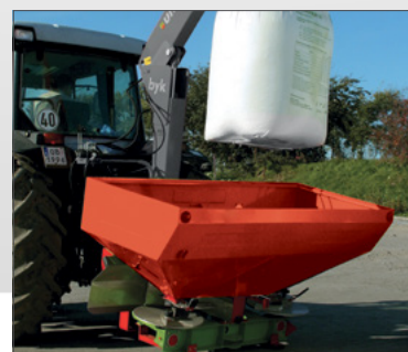
Навантажувач біг-бегів ВУК - дозволяє швидко завантаження добрив у бегах до 1000 кг
