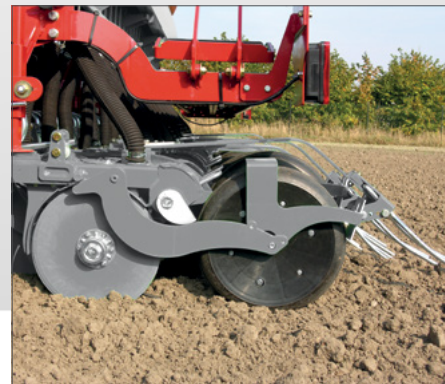
Важкий сошник з прикочуючим колесом дотиск 65 кг
