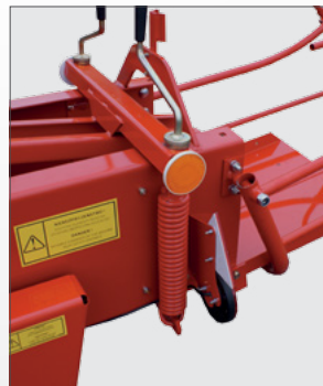
Регулювання ступеню стиску тюків - за допомогою двох пружин
