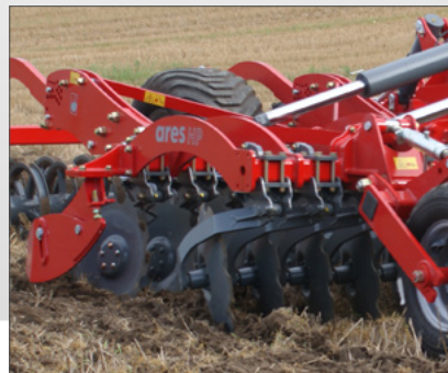
Діаметр та тип дисків забезпечують якісне підрізання та перемішування з ґрунтом великих кількостей рослинних залишків
